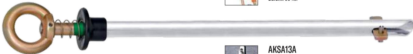
AKSA13 KOTVÍCÍ BOD PRO OCELOVÝ NOSNÍK OPAKOVANĚ POUŽITELNÉ EN 795: 2012 Kotevní bod pro nosníky o tloušťce nejméně 40 mm. Upevnění musí být provedeno otvorem o průměru mezi 21 a 30 mm. Kotva je opatřena indikátorem, že jde vidět zelené označení pokud bylo ukotvení provedeno správně. Odolné až do 23 kN. Balení: 30 ks.
